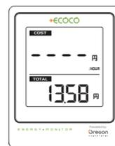
この場合、送信機と受信機の距離を短くして、受信機のアップボタンを長押しして、再度受信のリンクを行ってください。リンクが正常の場合、数字が表示されます。
